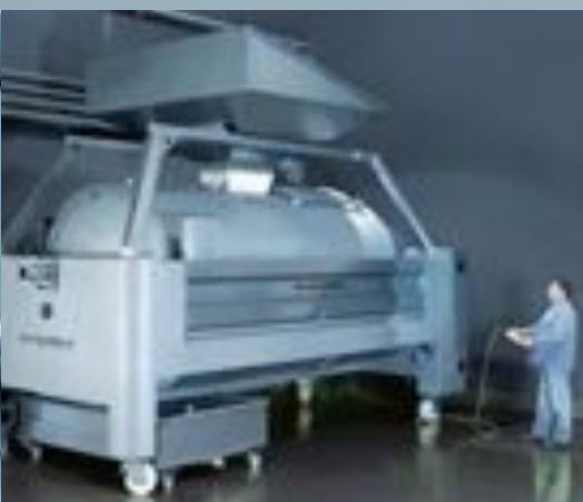
Europress T80 con recipiente para cargar
