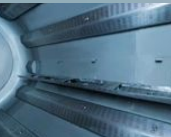
Limpieza fácil de los canales interiores rabatables
