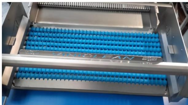
Con el resultado de la tolva vibradora, con el descenso de la añada, las púas envían los vegetales a la parte superior, las bayas pasan entre los discos y bajan a la bomba de tratamiento de la añada o a la mesa de clasificación. Los vegetales son eliminados por una pequeña cinta transportadora.
