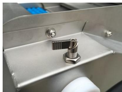
Posición de ajuste (posición arriba) Posición desbloqueo (posición abajo)
