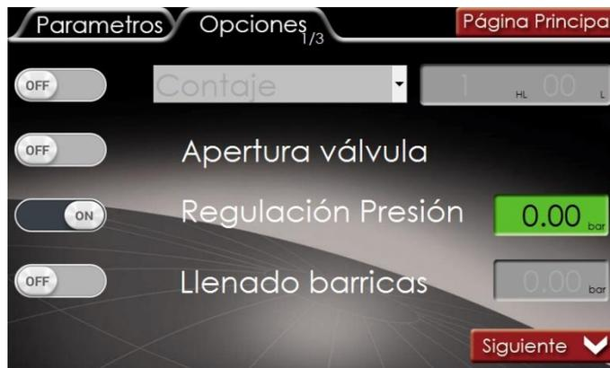
Marcar la presión requerida para la regulación (de 0,1 à 6,0 bares) introduciendo un valor en BAR en la zona táctil verde utilizando el teclado numérico :
