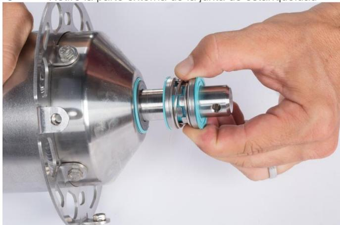
6- Retire la junta del eje utilizando 2 destornilladores de pala
