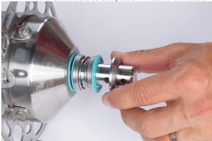
5- Retire la parte externa de la junta de estanqueidad
