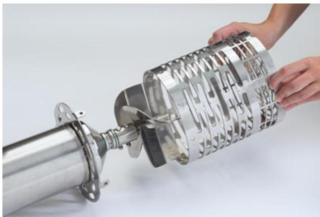
2- Desatornille las dos tuercas que mantienen el eje de la hélice en el árbol principal
