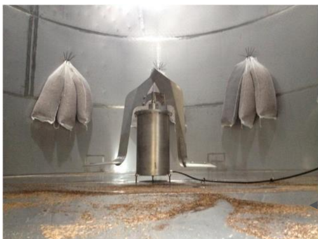
Fijación de un Bâtonneur XL en una cuba de acero inoxidable
