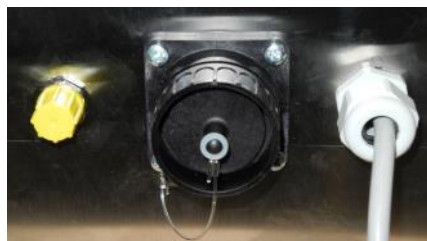
Conector M12 Scalya, Conector agitador, Prensaestopas para alimentación eléctrica
