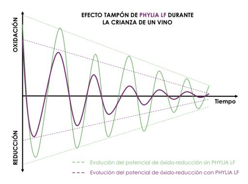
Gráfico: esquematización del efecto de **PHYLIA® LF** sobre el potencial de oxidoreducción del vino.
