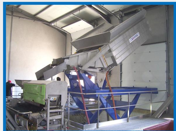
La profundidad de la caja es reducida, No puede producirse ningún amontonamiento o compactado ya que la vibración no se aplica a las uvas que están a la espera de descarga. Nuestro sistema funciona tanto para la vendimia manual como para la mecánica. Incluye un sistema de escurrido de altas prestaciones. La limpieza es muy rápida y el mantenimiento casi inexistente.
